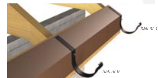
Haki montujemy od nr 1 do 10. Hak nr 10 będzie położony najniżej (bezpośrednio przy sztucerze).
