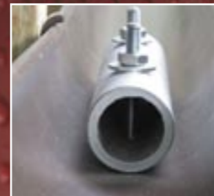
Stanoowisko badawcze w Instytucie Techniki Budowlanej. Rozstaw haków - 1180 mm obciążenie - 750 N
