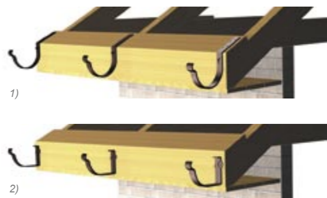
Przykład zastosowania haków rynnowych montowanych bezpośrednio do krokwi lub deski okapowej (1) lub haków combi (2) mocowanych do deski czołowej.
