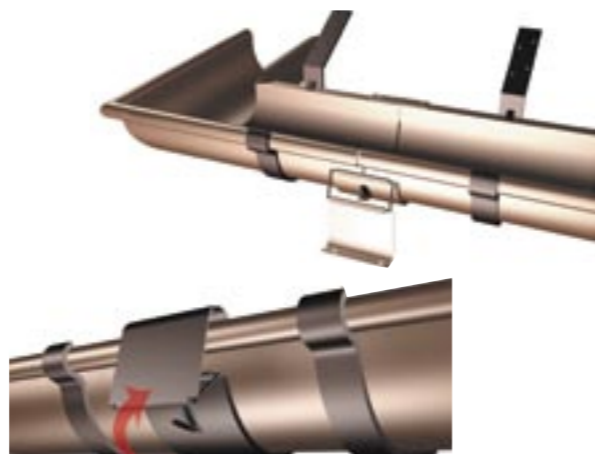
Złączkę zakładamy na łączone rynny i zatraskujemy. Pomiędzy rynnami należy zachować odstęp ok. 5 mm.
