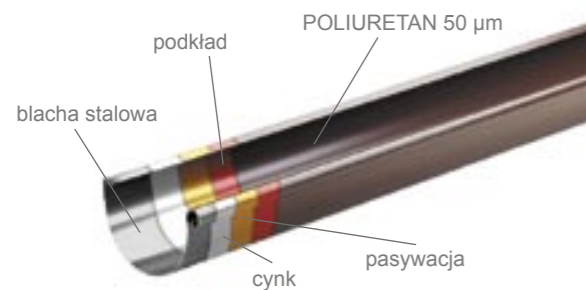
Układ warstw zabezpieczających
