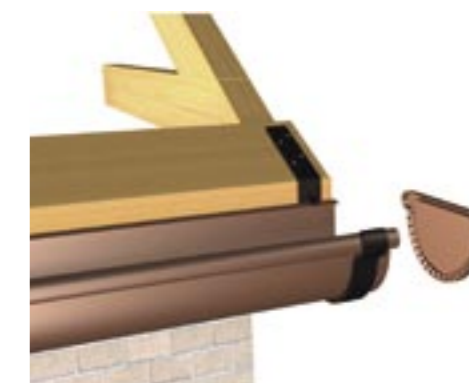
Denko montujemy po zamontowaniu rynny w uchwyty
