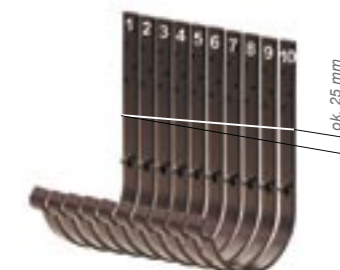
Metoda wyznaczenia odpowiedniego spadku - biała linia wyznacza miejsce, w którym należy zagiąć hak.
